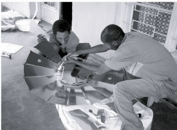
現地スタッフによるソーラークッカーの組み立て
